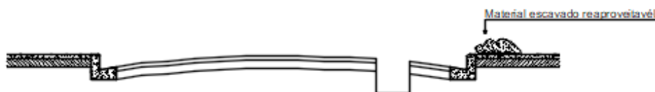
Figura 3: Representação da escavação no terço médio do passeio.
